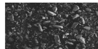
Perio-Mate パウダー(グリシン) 平均粒子径 25μm SEM画像(x150)
